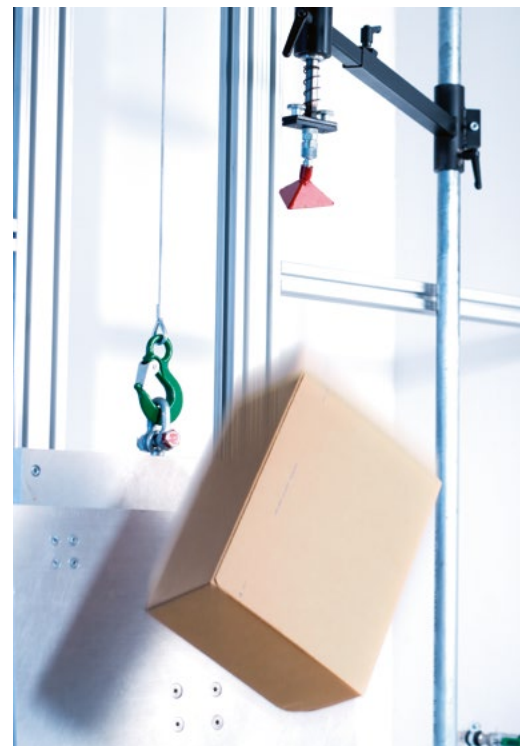
Test und Freigabe im eigenen Falltestlabor
