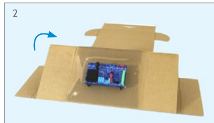
Seitenlasche umklappen, um Folie zu spannen
